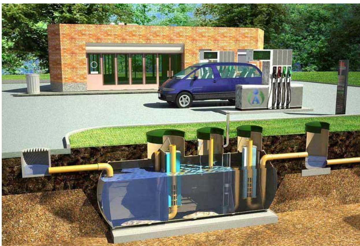
Рисунок 10. Схема очистного сооружения ливневой канализации.
