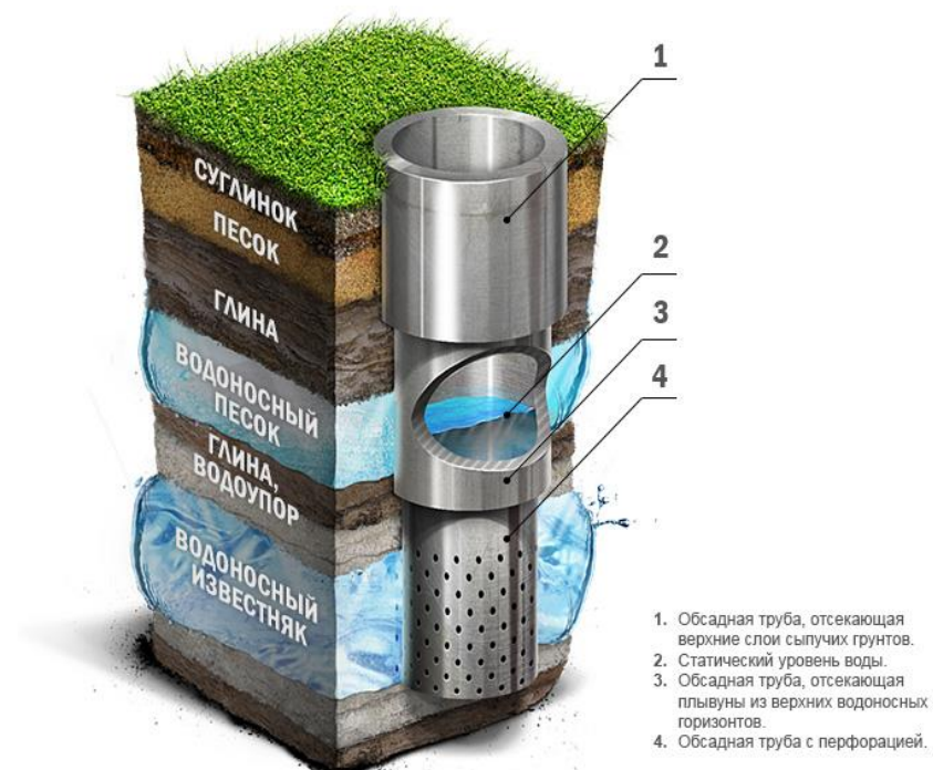
Рисунок 6. Схема артезианской скважины.
