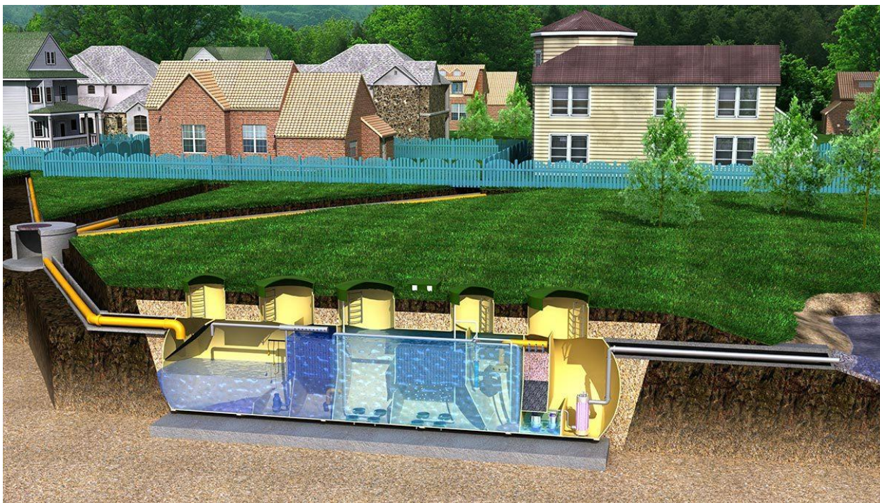
Рисунок 9. Схема биологической очистной станции.
